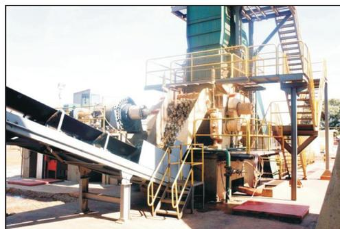
direcionadas, ainda por gravidade, para o tratamento VLC. Como resultado, a palha picada no terno sai com umidade menor que 60% e é misturada ao bagaço proveniente das moendas. "Dentre os principais benefícios gerados pelo projeto, destaca-se o ganho na capacidade de moagem, melhor extração das moendas, menor manutenção, menor desgaste e menor consumo de eletrodos.", enfatiza o Dr. Artur Alberto Ferretti, diretor adjunto industrial da empresa.
