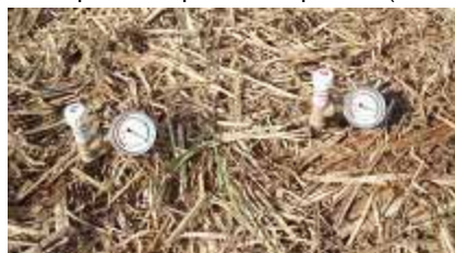
Foto 1. Tensiômetros instalados na Fazenda Rosário - Usina Açucareira Guairá
