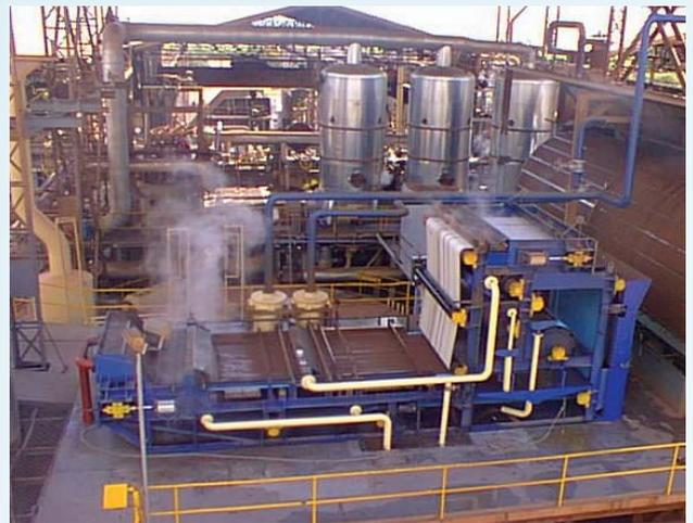
▲ Prensas desaguadoras da Marca TechPetersen tipo BeltPressvertical, única deste modelo instalada no Brasil.
